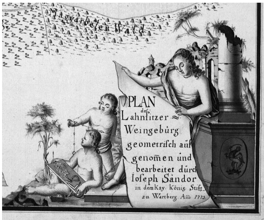
5. Részlet Sándor József szenci alumnusnak a cseklézi szőlőhegyet ábrázoló határtérképéről, 1773. A címereten földmérő eszközöket (lánc, térképes rajztábla, mérőkörző, fokmérő, díszes nyelű pontszűrő) és az Eszterházy család címerét ábrázolta (MNL OL, Magyar udvari kancelláriai térképek [S 85], n° 5).
